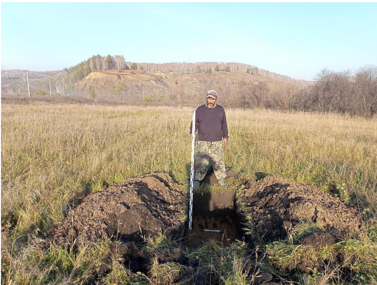
Рис. 94. «Подъездная автомобильная дорога необщего пользования...». Шурф №6 после выборки. Фото с 3.
