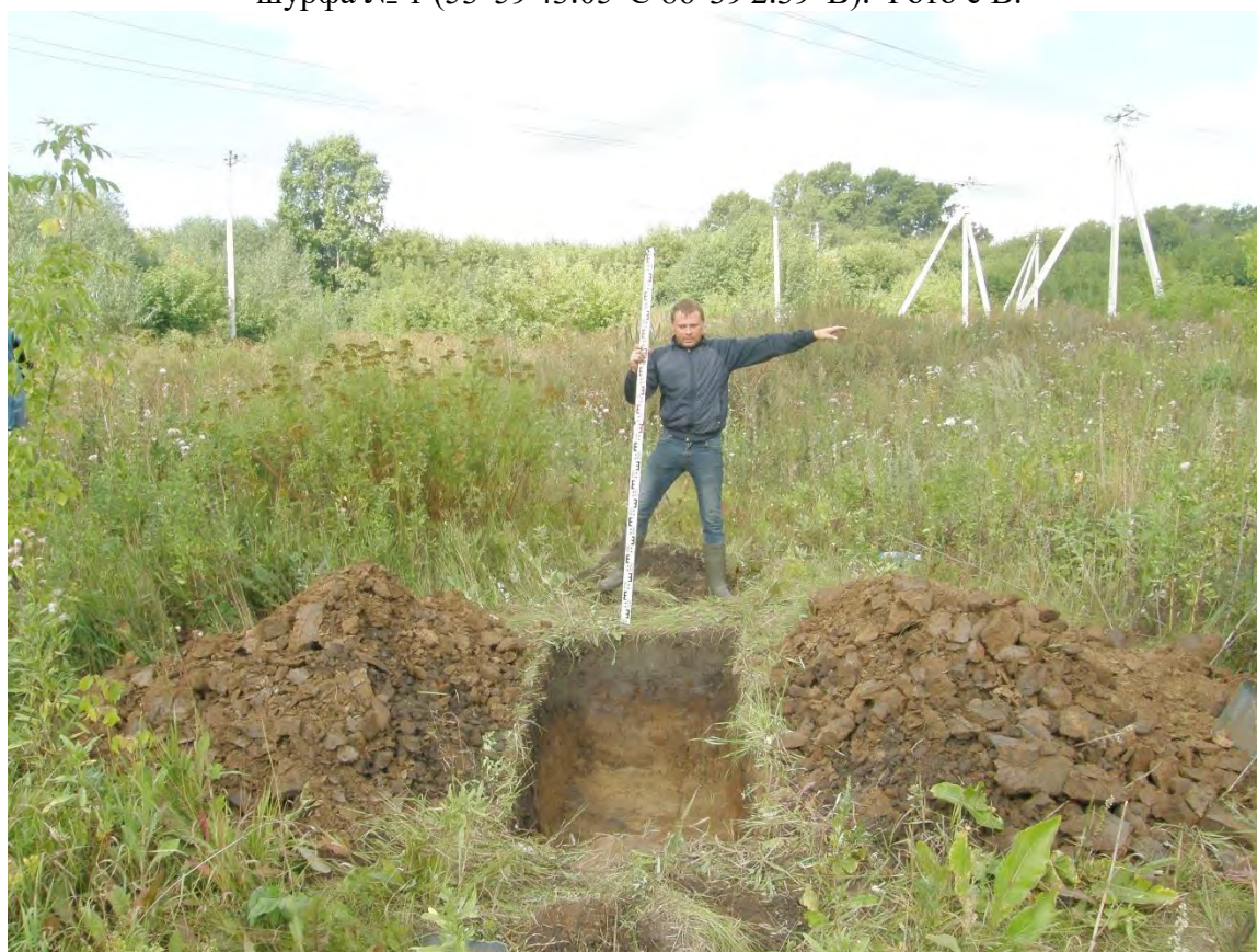
Рис. 53. Участки Коксовый Глубокий и Поле шахты им. Вахрушева. Шурф №1 после выборки. Фото с В.
