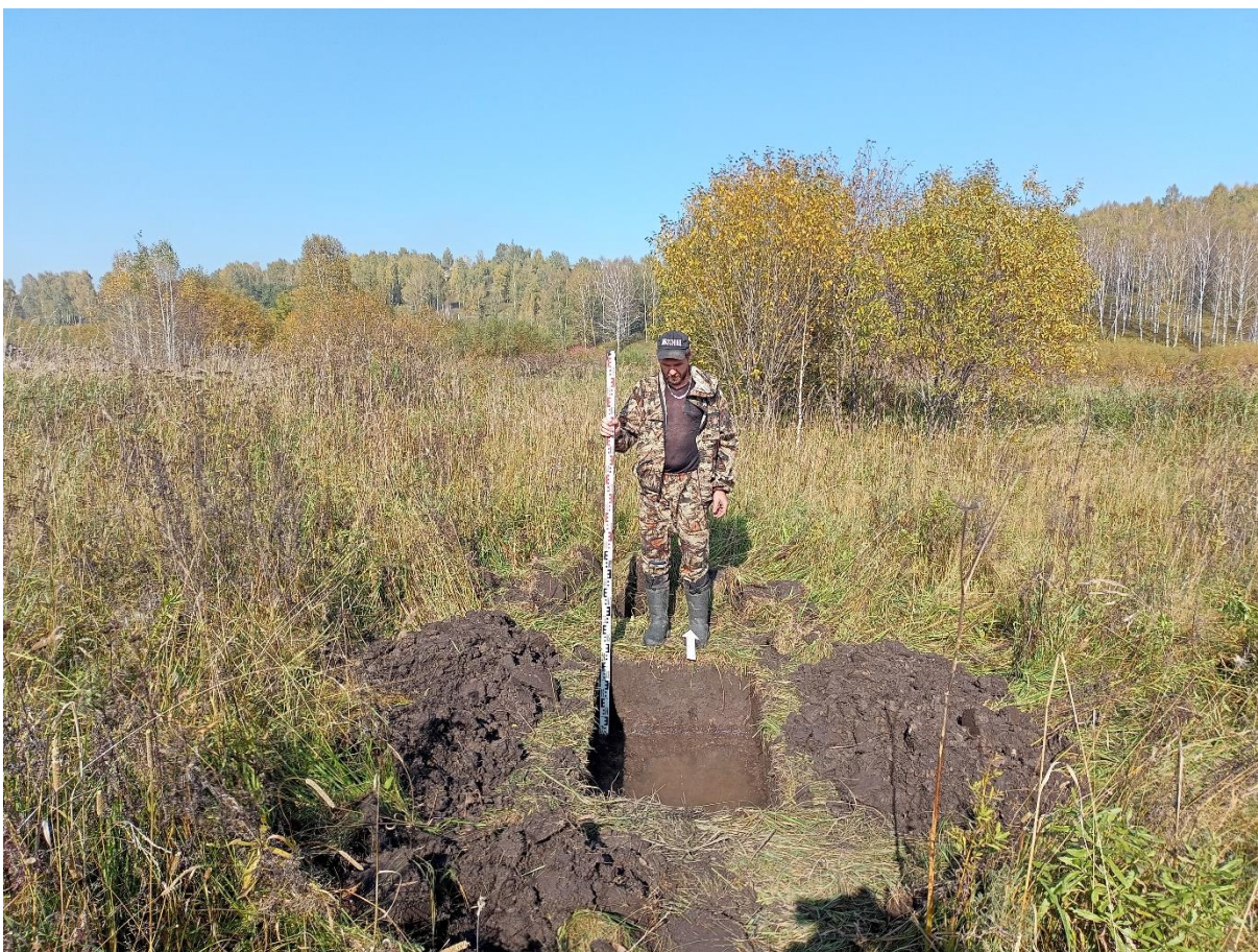
Рис. 91. «Строительство канализационной и тепловой сетей п. Новосафоновский». Шурф №1 после выборки. Фото с Ю.
