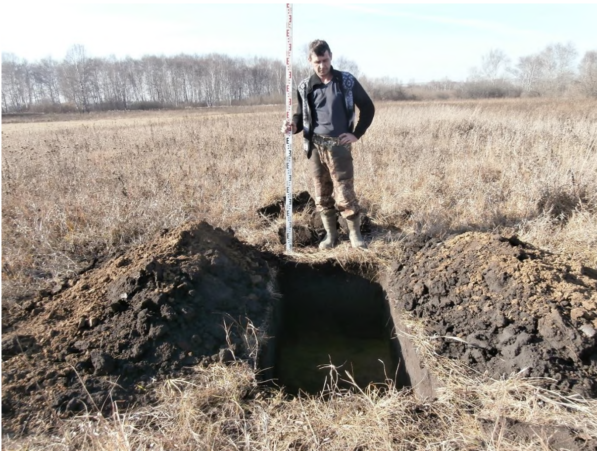
Рис. 118. «Строительство одной двухцепной отпайки .... КеНоТЭК». Шурф №2 после выборки. Фото с С.
