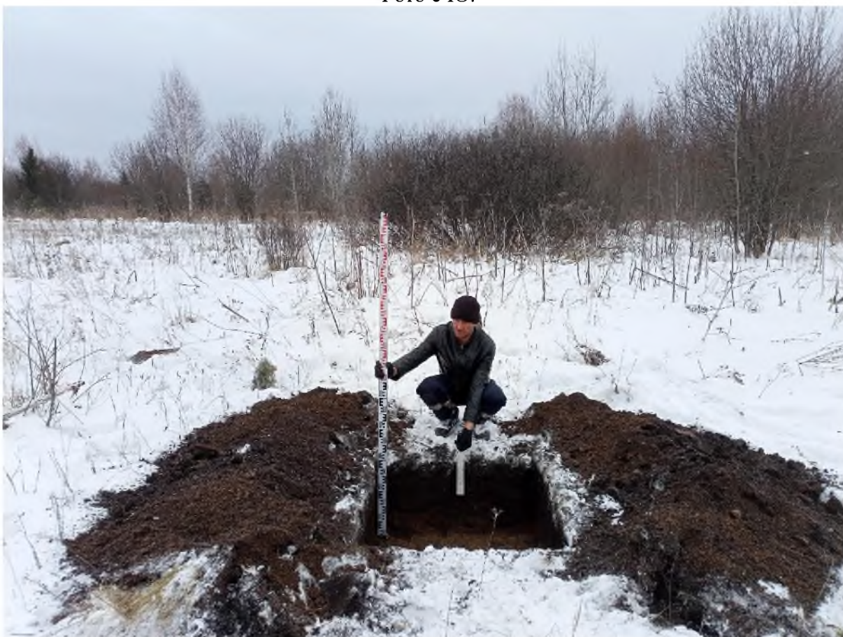
Рис. 1143. «Технический проект разработки Анжерского каменноугольного месторождения...». Шурф №168 после выборки. Фото с Ю.
