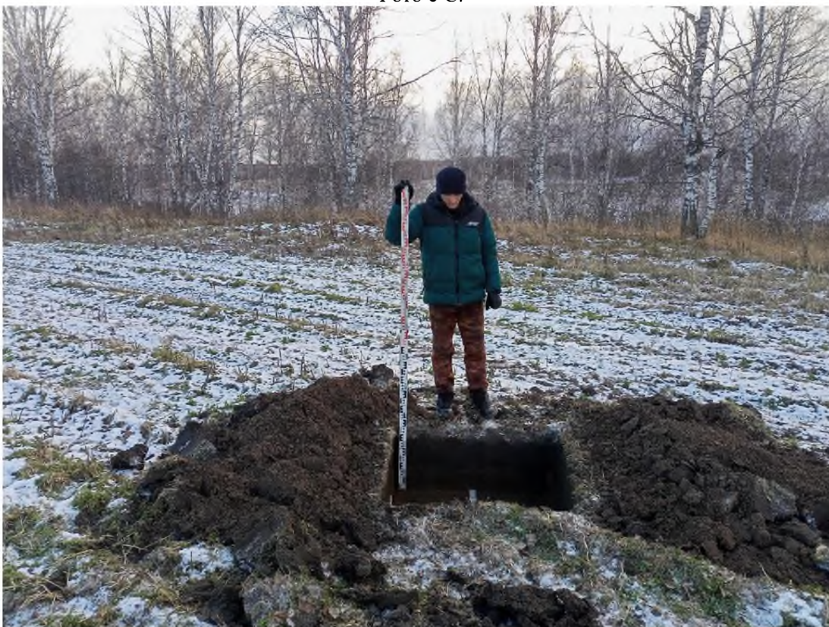
Рис. 643. «Технический проект разработки Анжерского каменноугольного месторождения...». Шурф №43 после выборки. Фото с С.
