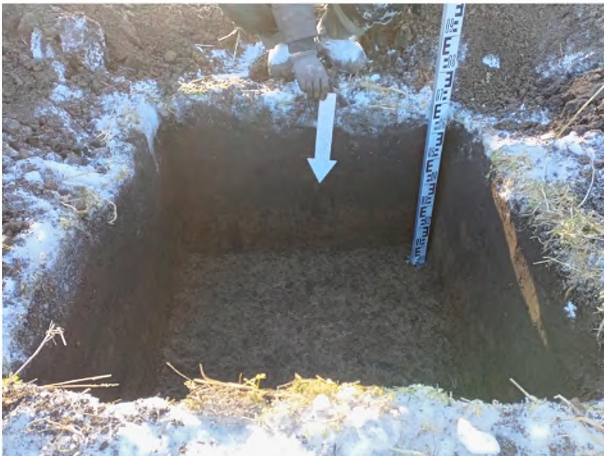
Рис. 1040. «Технический проект разработки Анжерского каменноугольного месторождения...». Шурф №142. Профиль южной стенки. Фото с С.
