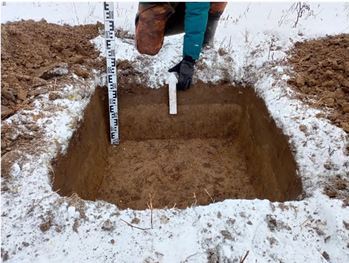
Рис. 936. «Технический проект разработки Анжерского каменноугольного месторождения...». Шурф №116. Профиль северной стенки. Фото с Ю.
