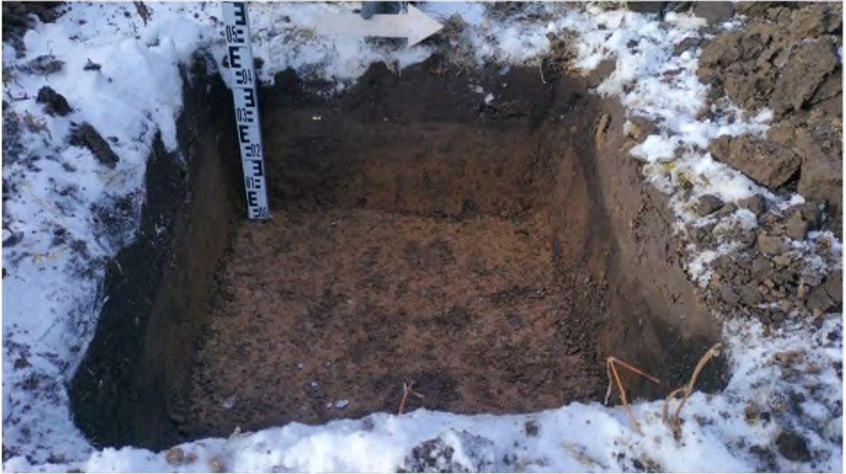
Рис. 884. «Технический проект разработки Анжерского каменноугольного месторождения...». Шурф №103. Профиль западной стенки. Фото с В.
