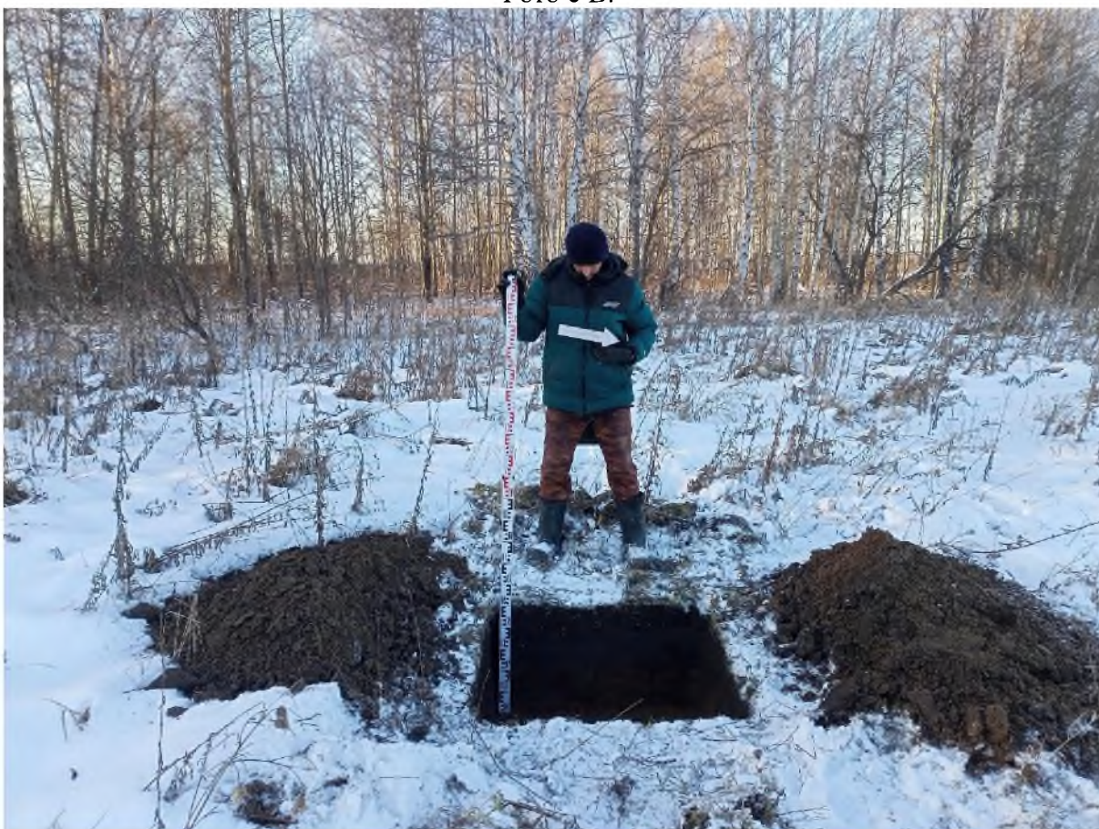
Рис. 1019. «Технический проект разработки Анжерского каменноугольного месторождения...». Шурф №137 после выборки. Фото с В.
