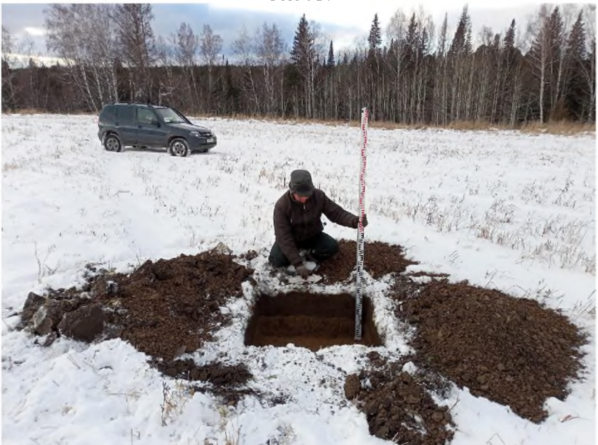
Рис. 915. «Технический проект разработки Анжерского каменноугольного месторождения...». Шурф №111 после выборки. Фото с В.
