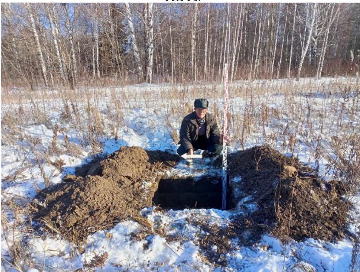
Рис. 995. «Технический проект разработки Анжерского каменноугольного месторождения...». Шурф №131 после выборки. Фото с 3.
