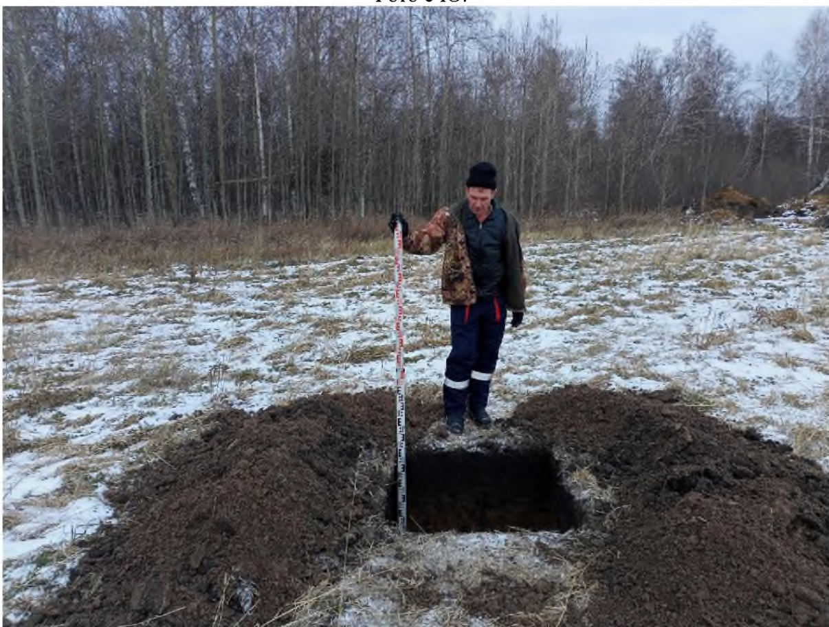
Рис. 579. «Технический проект разработки Анжерского каменноугольного месторождения...». Шурф №27 после выборки. Фото с Ю.
