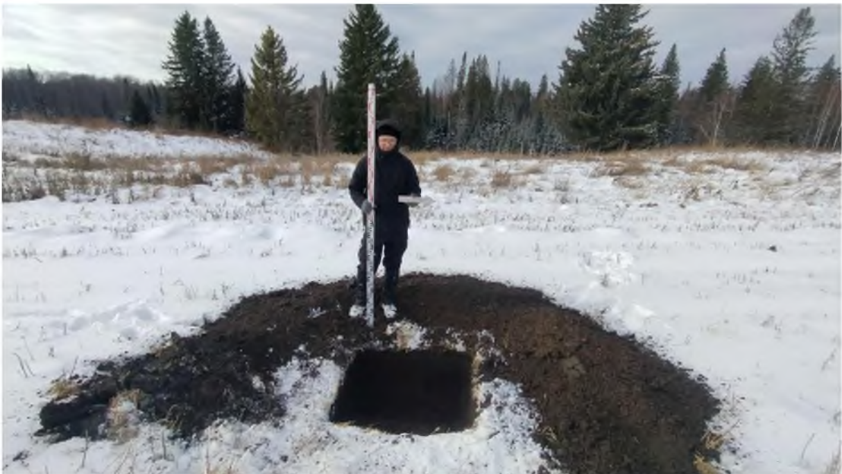
Рис. 887. «Технический проект разработки Анжерского каменноугольного месторождения...». Шурф №104 после выборки. Фото с В.
