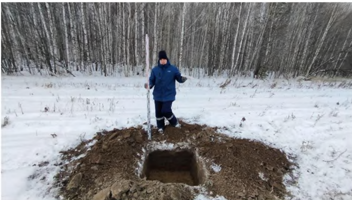
Рис. 811. «Технический проект разработки Анжерского каменноугольного месторождения...». Шурф №85 после выборки. Фото с В.
