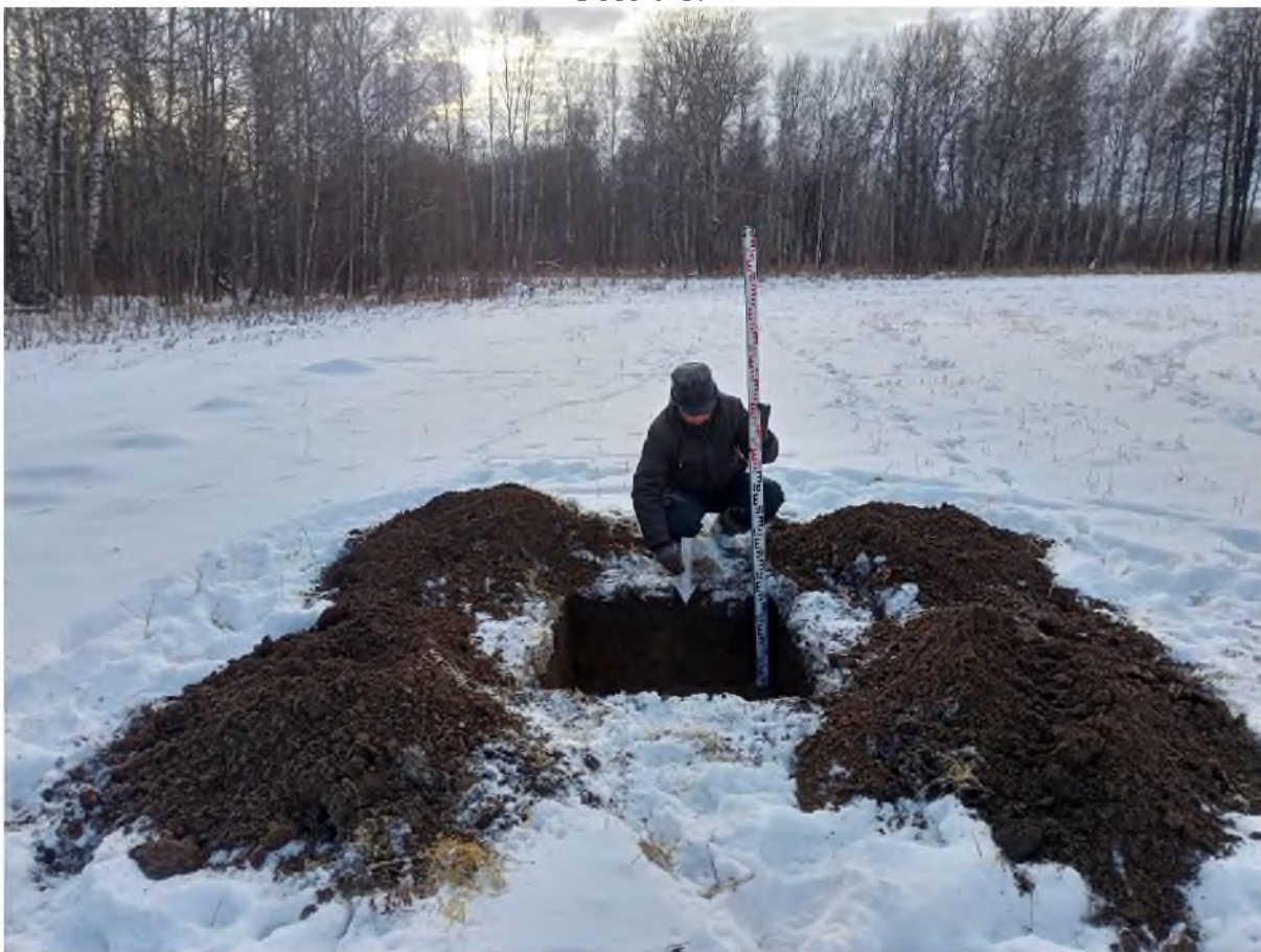
Рис. 987. «Технический проект разработки Анжерского каменноугольного месторождения...». Шурф №129 после выборки. Фото с С.
