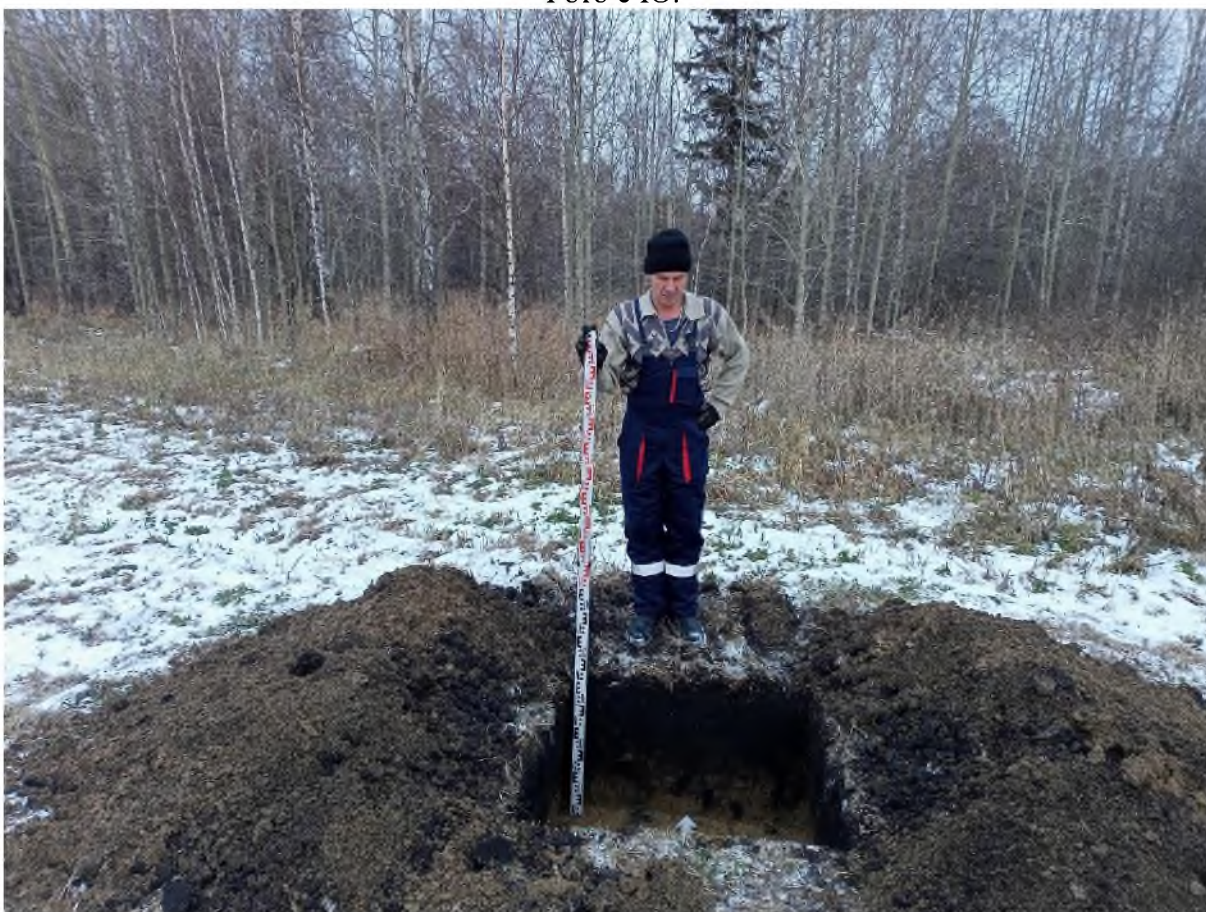
Рис. 607. «Технический проект разработки Анжерского каменноугольного месторождения...». Шурф №34 после выборки. Фото с Ю.
