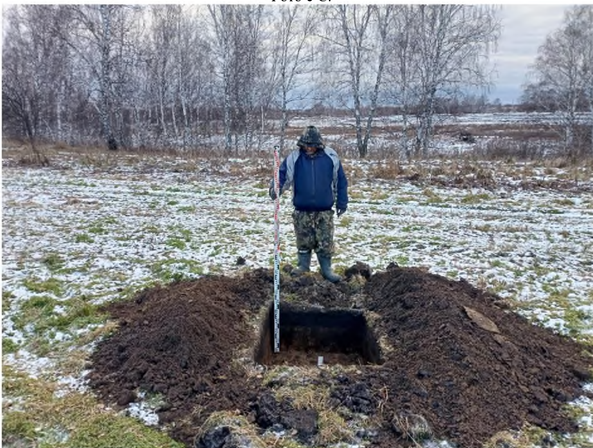
Рис. 639. «Технический проект разработки Анжерского каменноугольного месторождения...». Шурф №42 после выборки. Фото с С.
