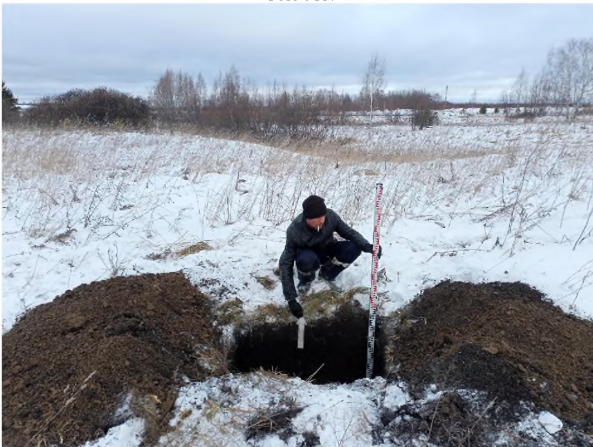
Рис. 1103. «Технический проект разработки Анжерского каменноугольного месторождения...». Шурф №158 после выборки. Фото с Ю.
