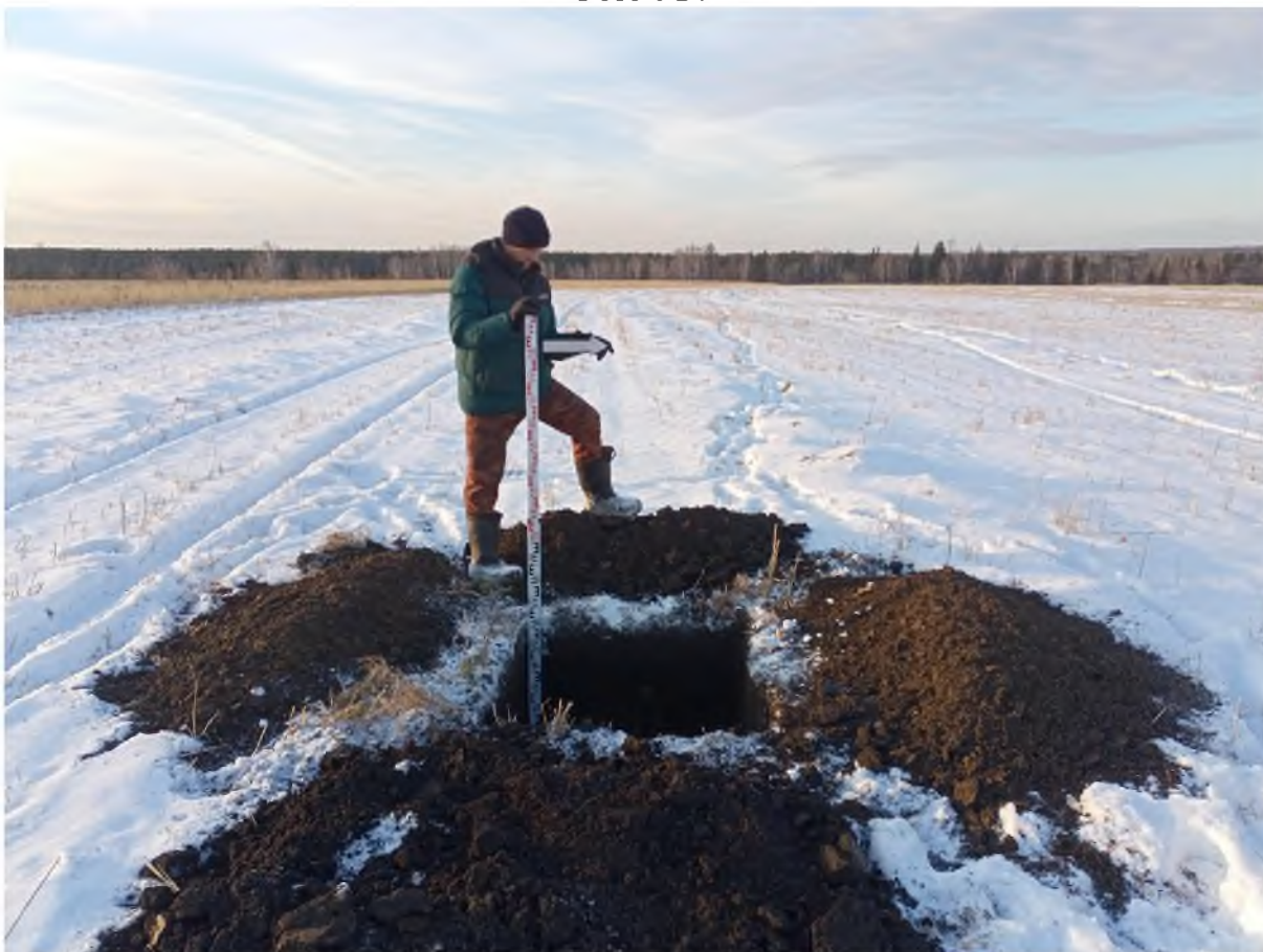
Рис. 1059. «Технический проект разработки Анжерского каменноугольного месторождения...». Шурф №147 после выборки. Фото с В.
