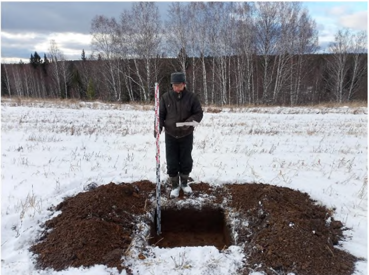
Рис. 907. «Технический проект разработки Анжерского каменноугольного месторождения...». Шурф №109 после выборки. Фото с В.
