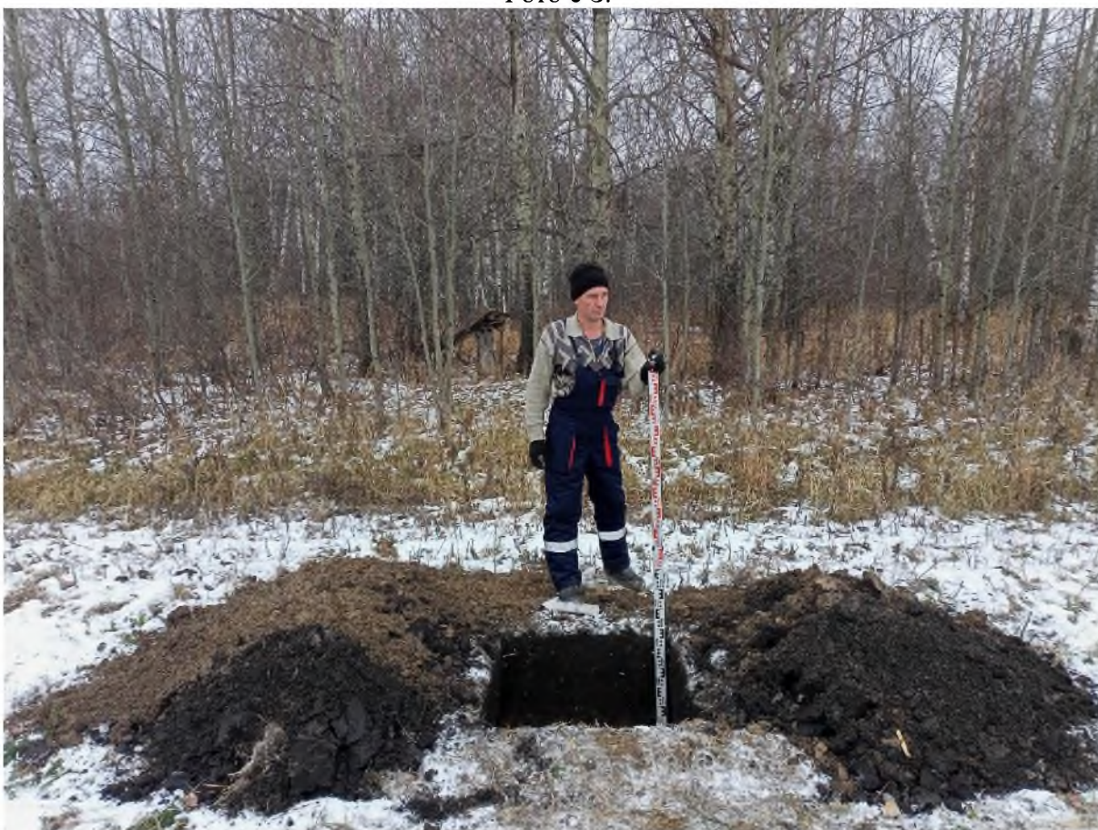
Рис. 603. «Технический проект разработки Анжерского каменноугольного месторождения...». Шурф №33 после выборки. Фото с 3.
