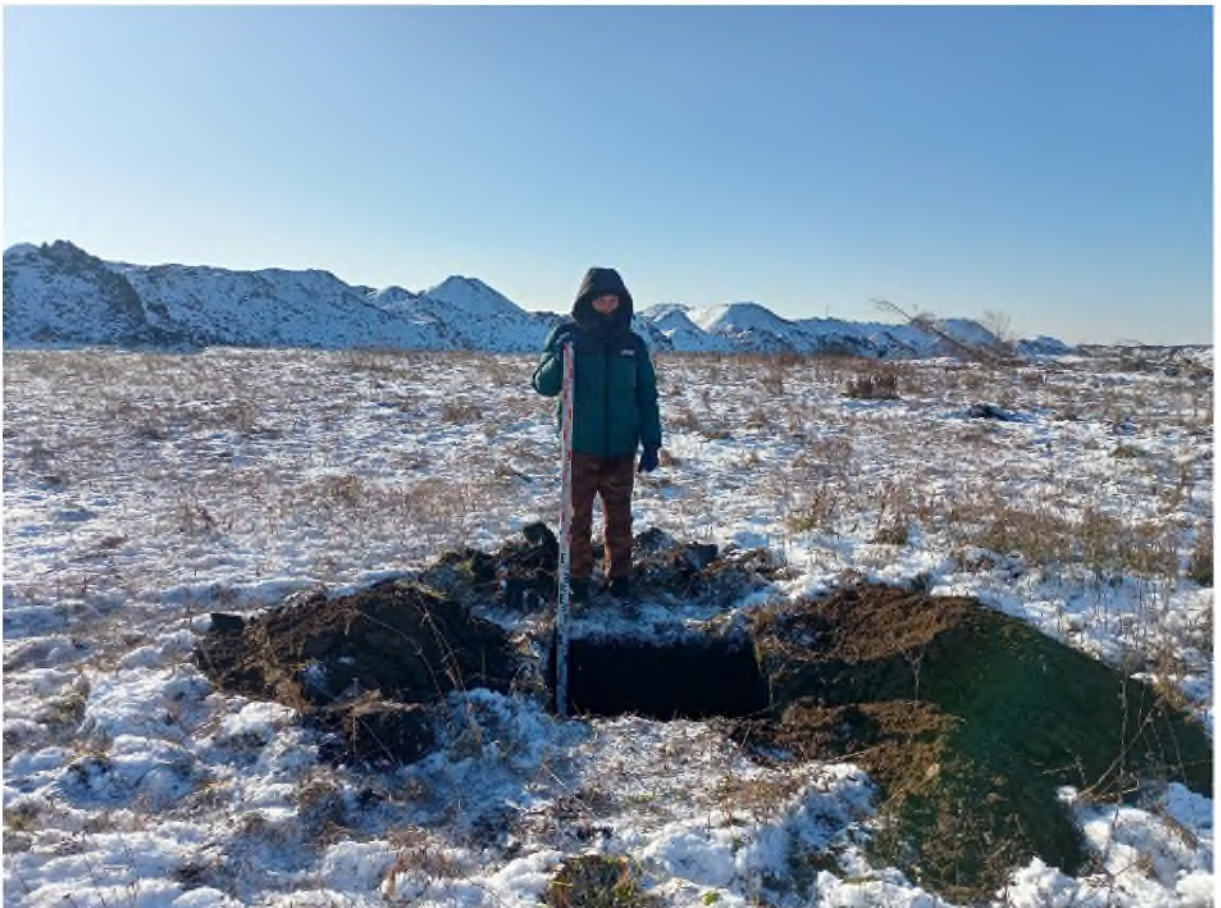
Рис. 495. «Технический проект разработки Анжерского каменноугольного месторождения...». Шурф №6 после выборки. Фото с С.
