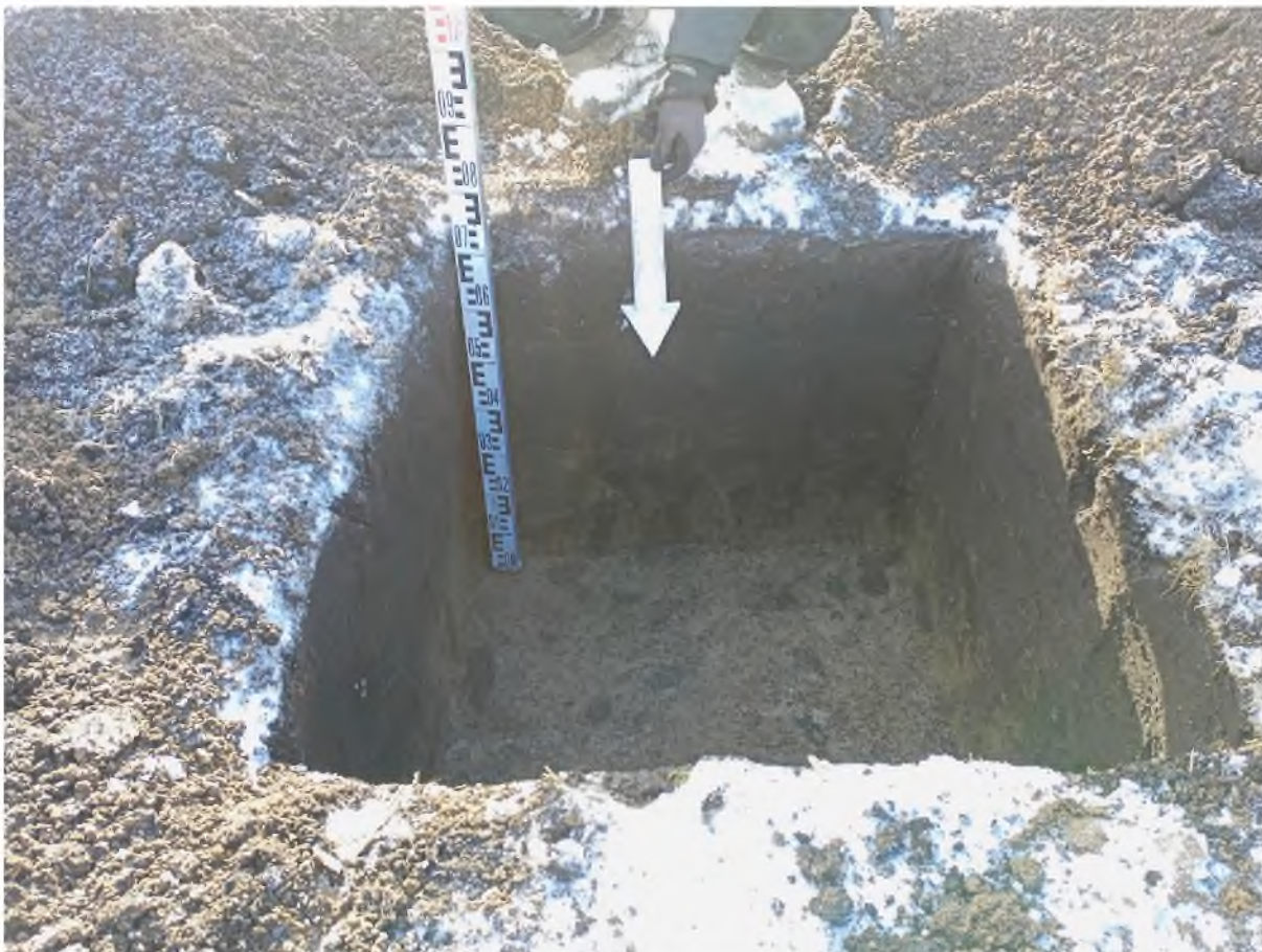
Рис. 868. «Технический проект разработки Анжерского каменноугольного месторождения...». Шурф №99. Профиль южной стенки. Фото с С.
