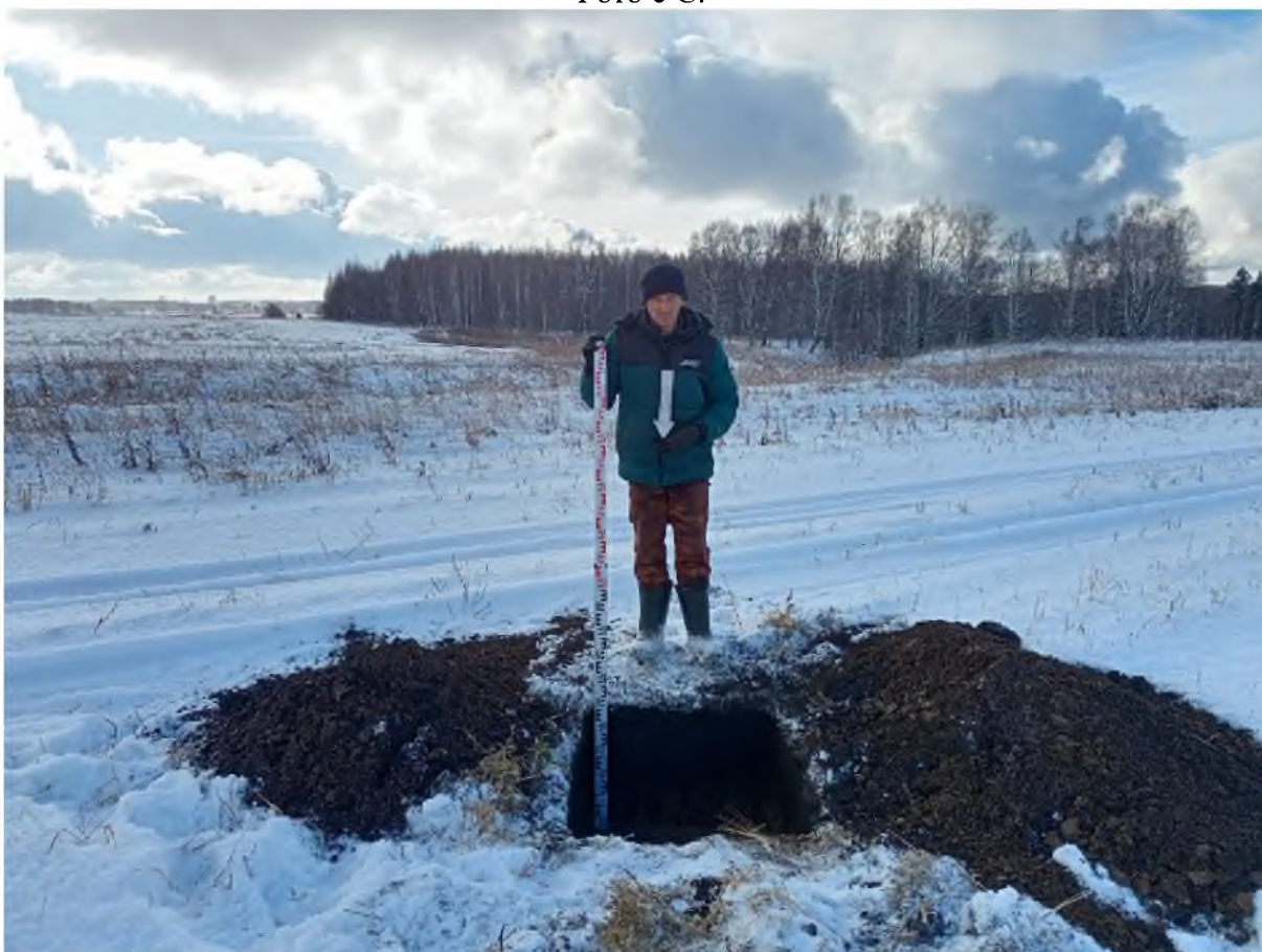
Рис. 871. «Технический проект разработки Анжерского каменноугольного месторождения...». Шурф №100 после выборки. Фото с С.
