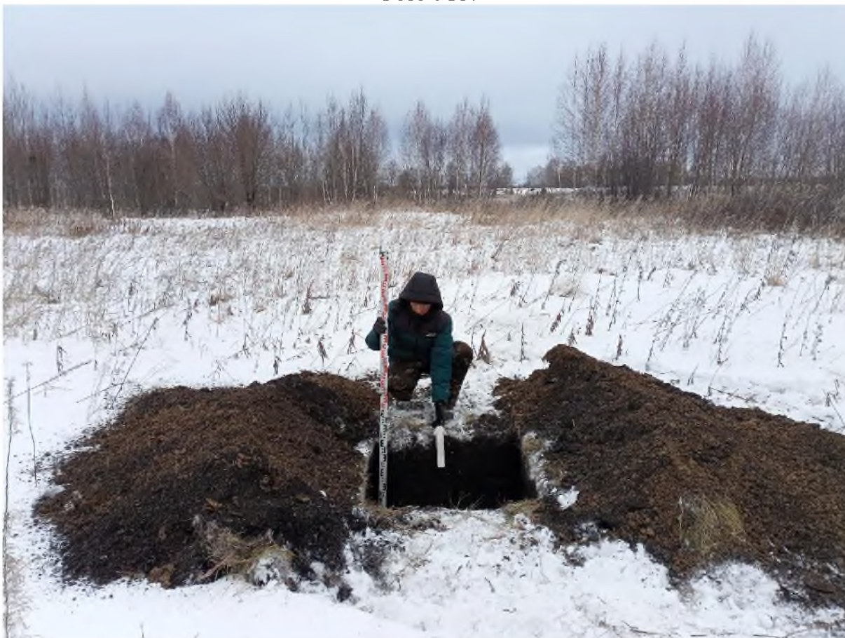
Рис. 1107. «Технический проект разработки Анжерского каменноугольного месторождения...». Шурф №159 после выборки. Фото с Ю.
