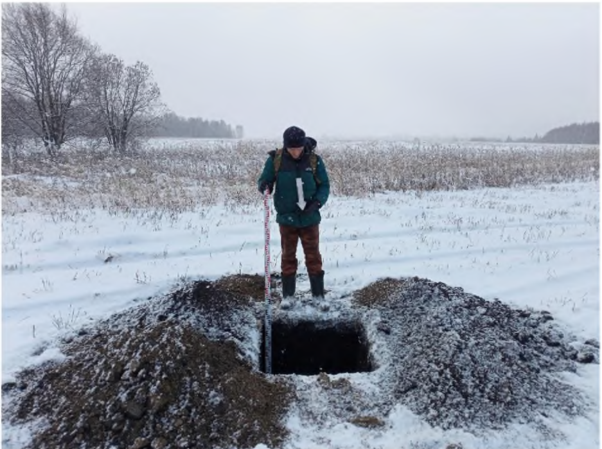
Рис. 863. «Технический проект разработки Анжерского каменноугольного месторождения...». Шурф №98 после выборки. Фото с С.
