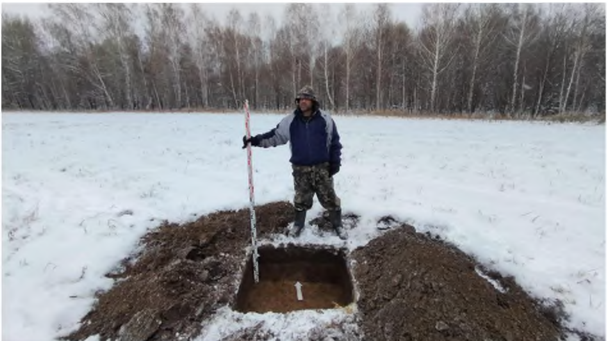
Рис. 755. «Технический проект разработки Анжерского каменноугольного месторождения...». Шурф №71 после выборки. Фото с Ю.
