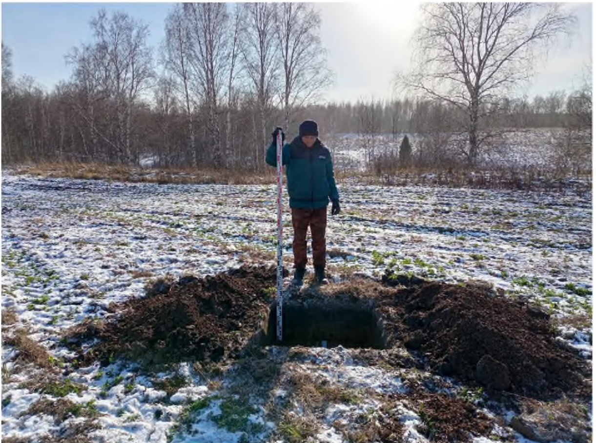
Рис. 663. «Технический проект разработки Анжерского каменноугольного месторождения...». Шурф №48 после выборки. Фото с С.
