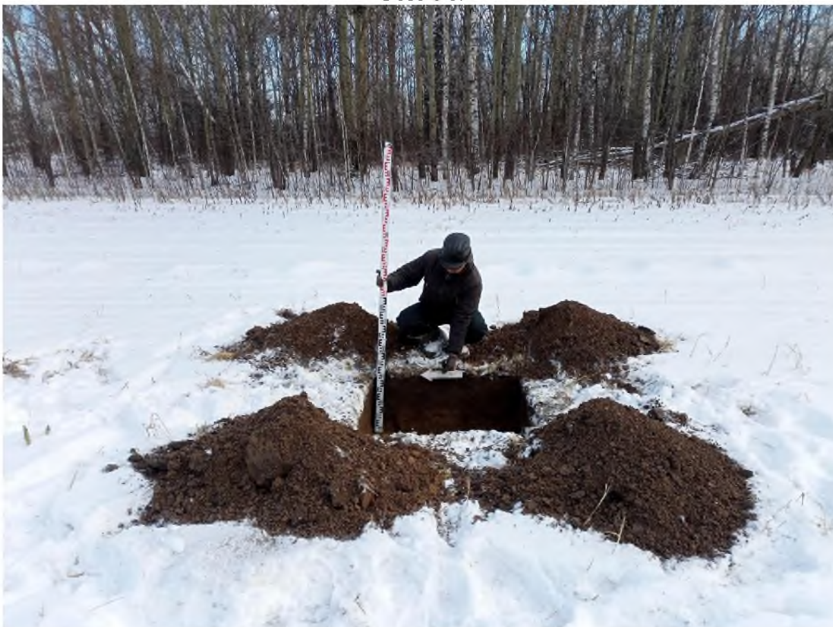
Рис. 983. «Технический проект разработки Анжерского каменноугольного месторождения...». Шурф №128 после выборки. Фото с 3.
