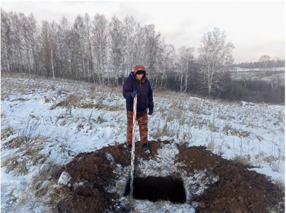
Рис. 483. «Технический проект разработки Анжерского каменноугольного месторождения...». Шурф №3 после выборки. Фото с Ю.
