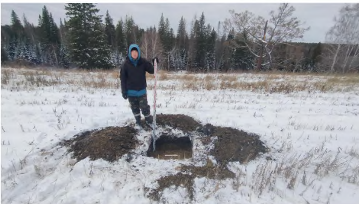
Рис. 895. «Технический проект разработки Анжерского каменноугольного месторождения...». Шурф №106 после выборки. Фото с В.
