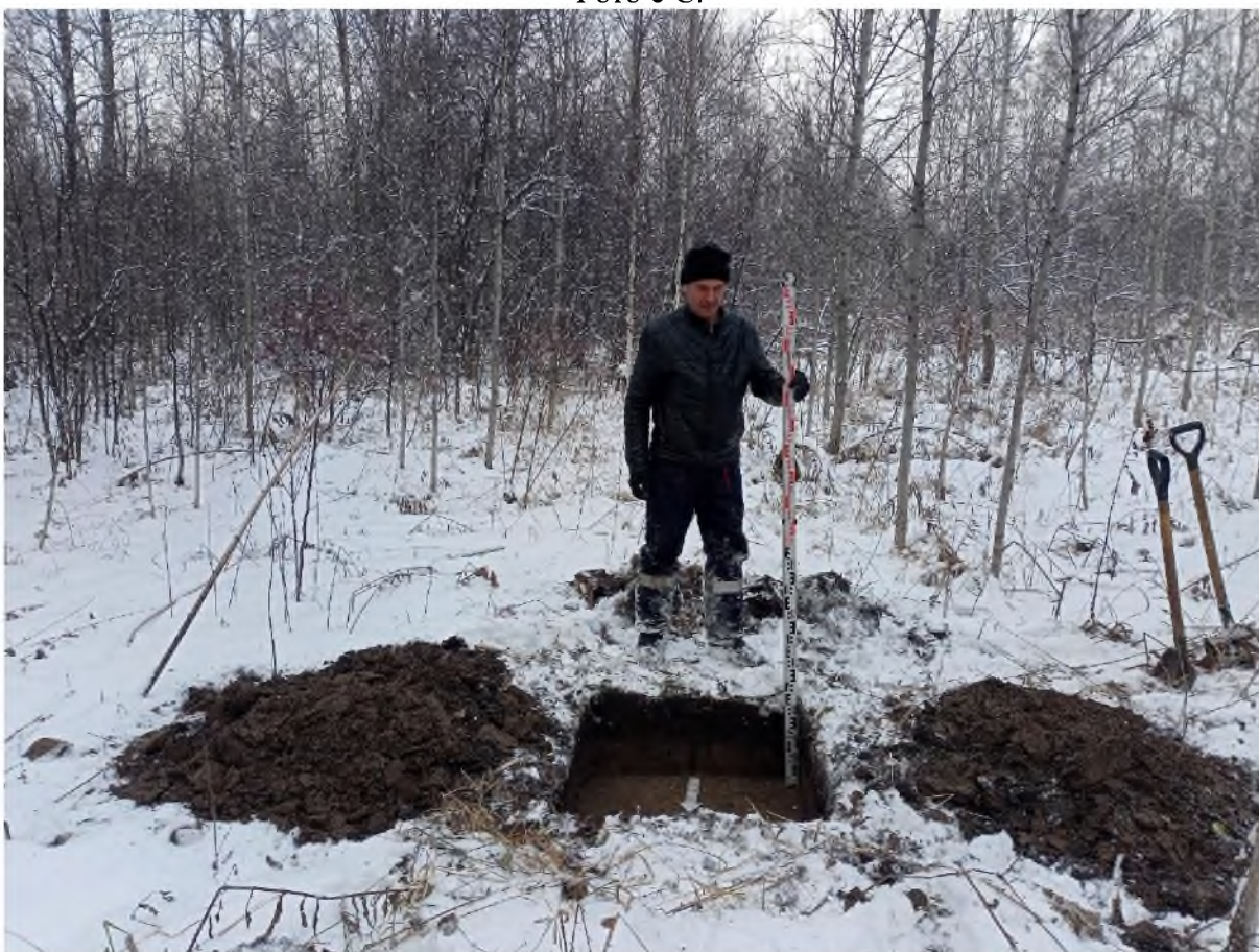
Рис. 723. «Технический проект разработки Анжерского каменноугольного месторождения...». Шурф №63 после выборки. Фото с С.
