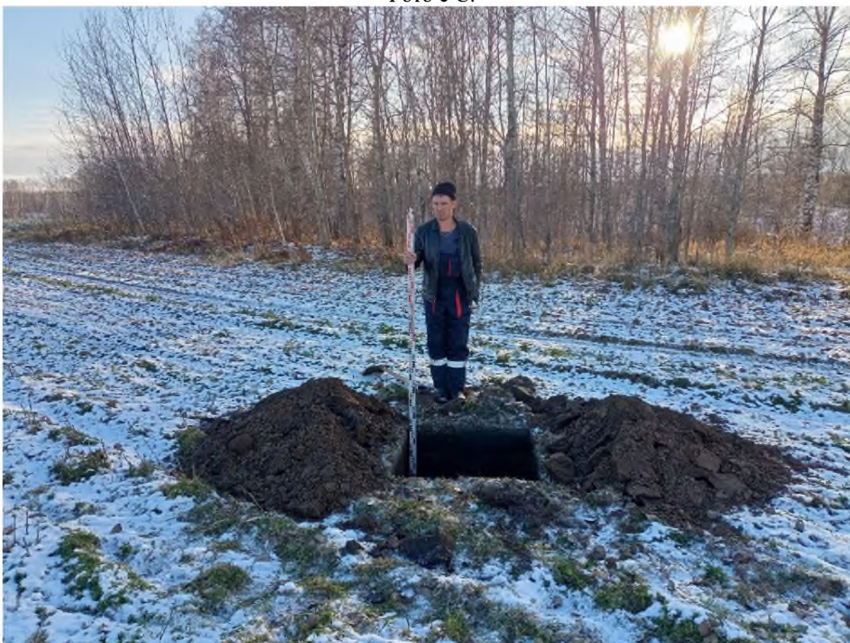
Рис. 651. «Технический проект разработки Анжерского каменноугольного месторождения...». Шурф №45 после выборки. Фото с С.
