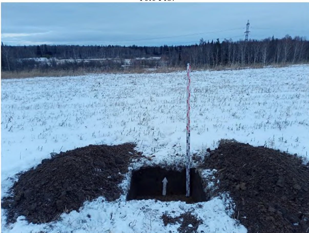
Рис. 923. «Технический проект разработки Анжерского каменноугольного месторождения...». Шурф №113 после выборки. Фото с Ю.
