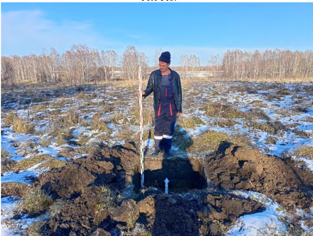
Рис. 667. «Технический проект разработки Анжерского каменноугольного месторождения...». Шурф №49 после выборки. Фото с Ю.
