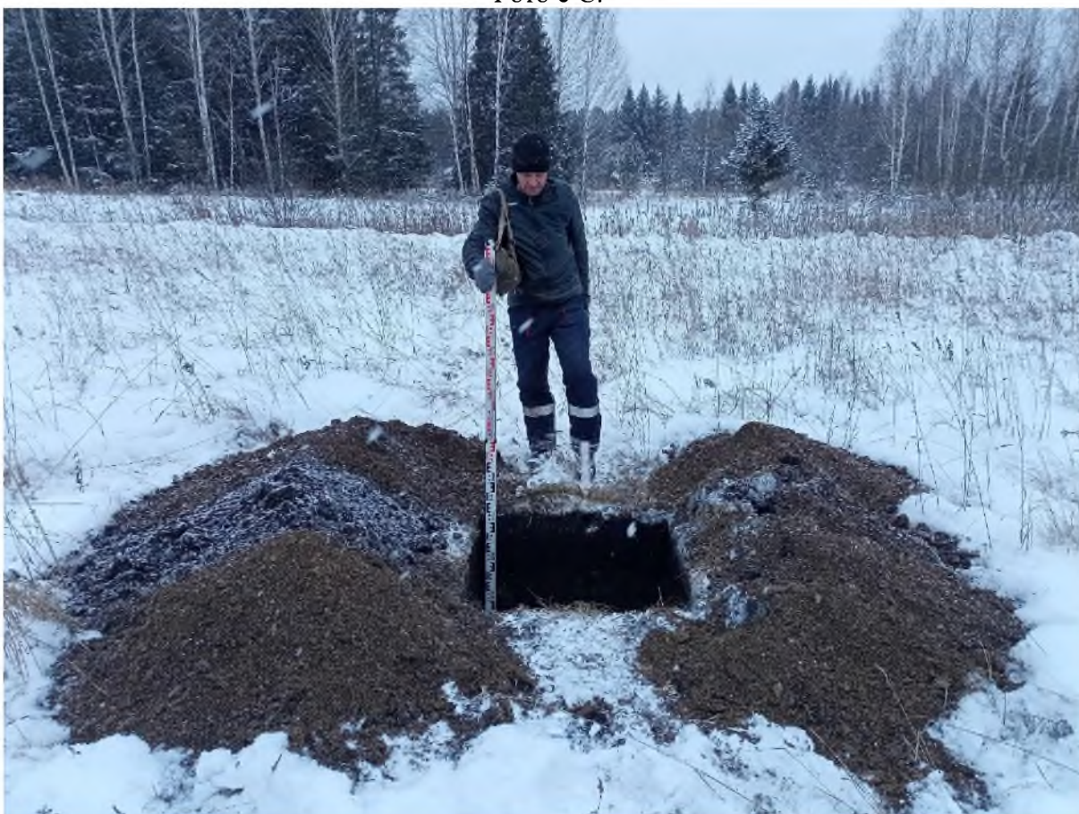
Рис. 1071. «Технический проект разработки Анжерского каменноугольного месторождения...». Шурф №150 после выборки. Фото с С.
