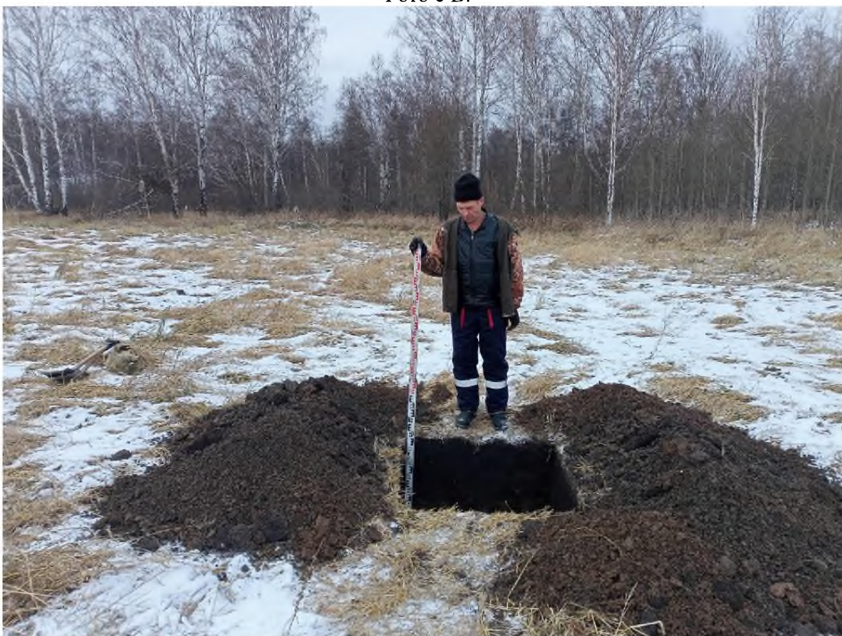
Рис. 575. «Технический проект разработки Анжерского каменноугольного месторождения...». Шурф №26 после выборки. Фото с В.
