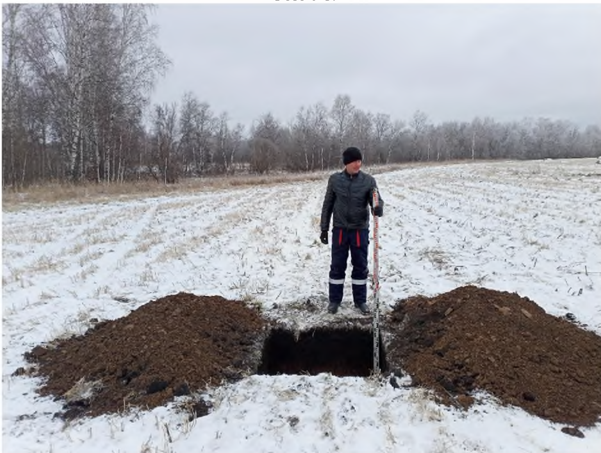
Рис. 551. «Технический проект разработки Анжерского каменноугольного месторождения...». Шурф №20 после выборки. Фото с С.
