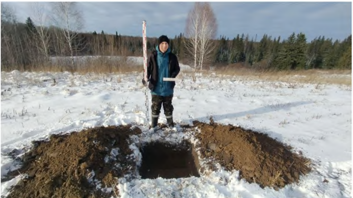
Рис. 879. «Технический проект разработки Анжерского каменноугольного месторождения...». Шурф №102 после выборки. Фото с В.
