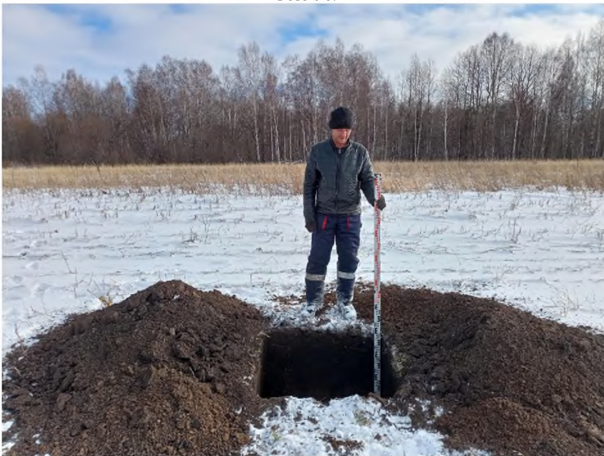
Рис. 779. «Технический проект разработки Анжерского каменноугольного месторождения...». Шурф №77 после выборки. Фото с 3.
