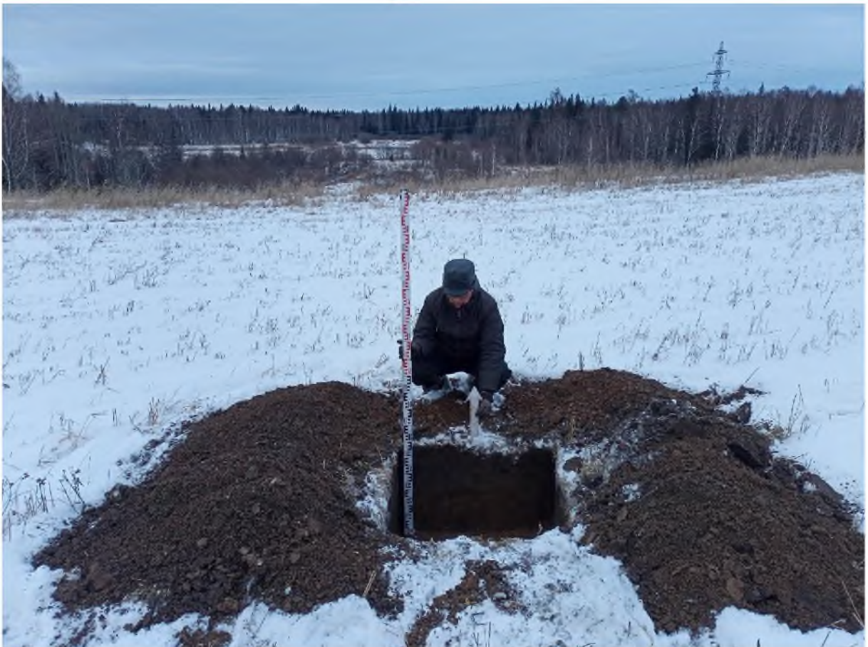
Рис. 919. «Технический проект разработки Анжерского каменноугольного месторождения...». Шурф №112 после выборки. Фото с Ю.
