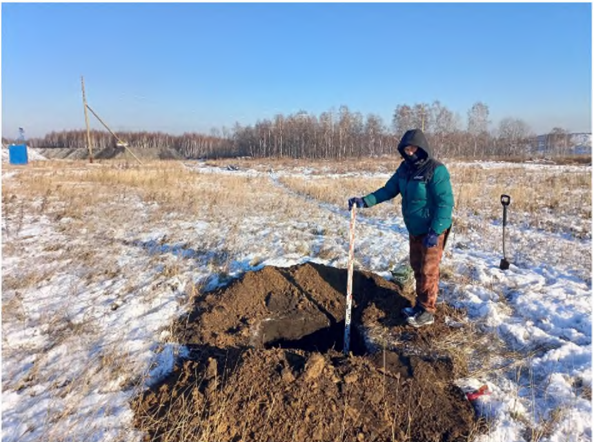
Рис. 491. «Технический проект разработки Анжерского каменноугольного месторождения...». Шурф №5 после выборки. Фото с 3.
