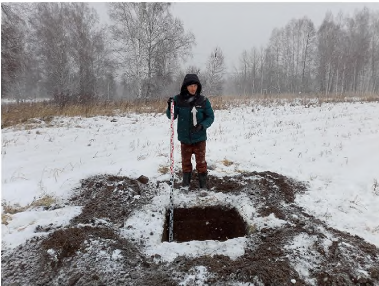
Рис. 967. «Технический проект разработки Анжерского каменноугольного месторождения...». Шурф №124 после выборки. Фото с Ю.
