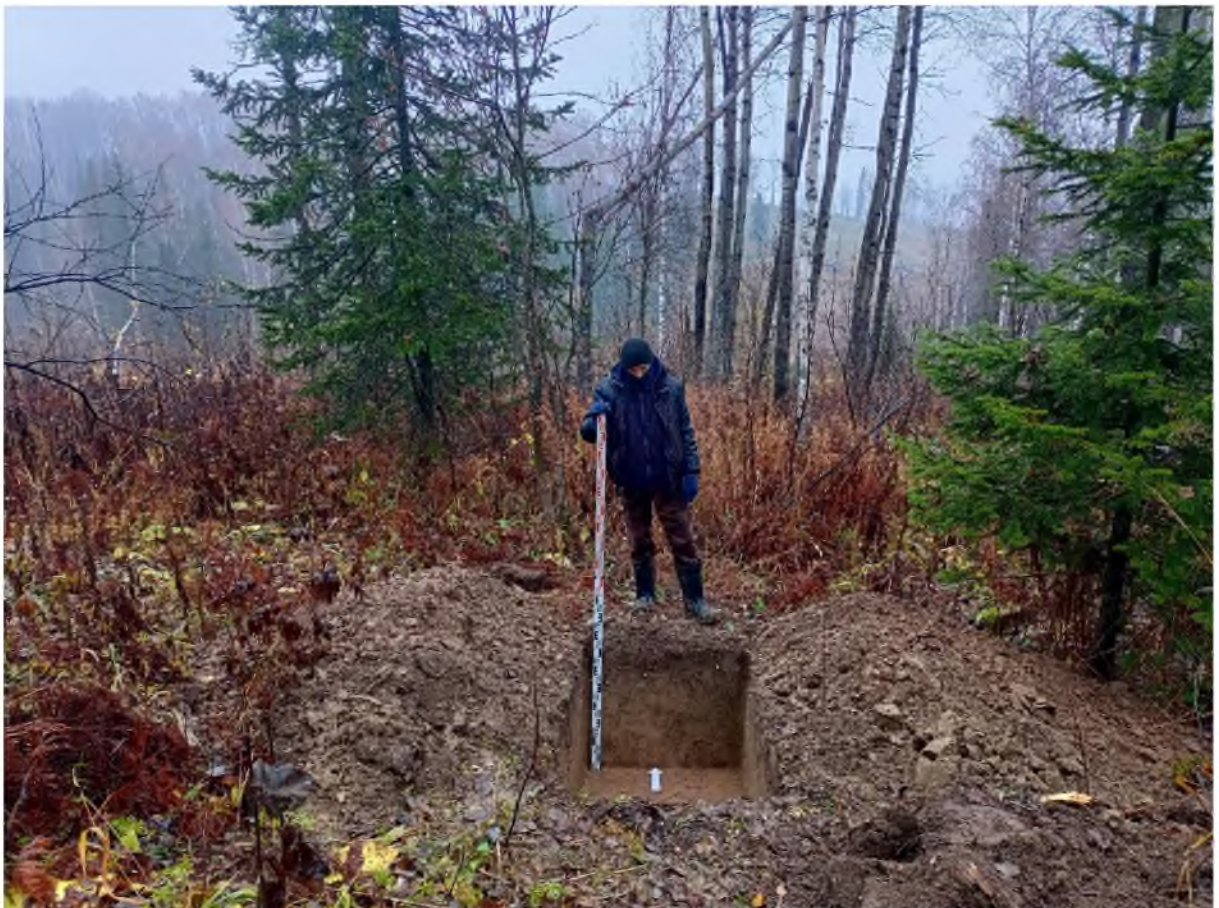
Рис. 57. «Технический проект разработки Увального каменноугольного месторождения». Участок 1. Шурф №2 после выборки. Фото с Ю.
