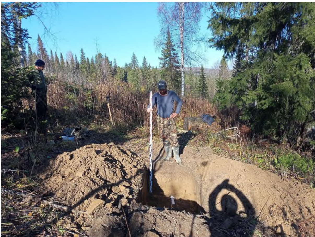
Рис. 81. «Технический проект разработки Увального каменноугольного месторождения». Участок 1. Шурф №8 после выборки. Фото с Ю.
