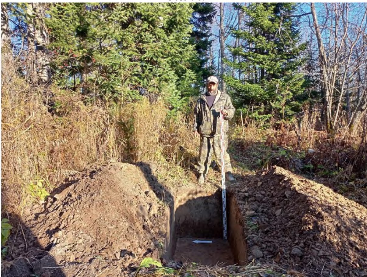
Рис. 180. «Технический проект разработки Увального каменноугольного месторождения». Участок 2. Шурф №14 после выборки. Фото с 3.
