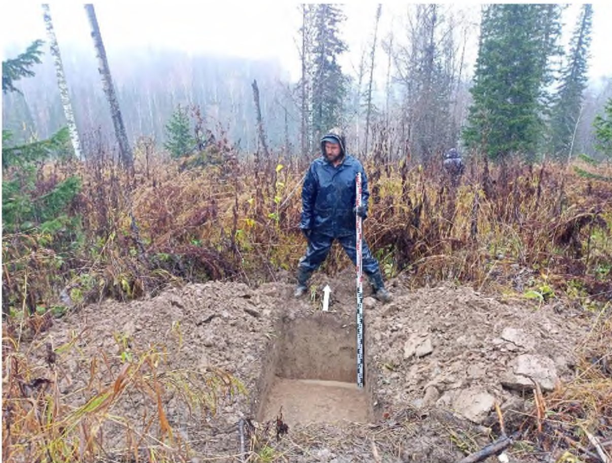
Рис. 53. «Технический проект разработки Увального каменноугольного месторождения». Участок 1. Шурф №1 после выборки. Фото с Ю.
