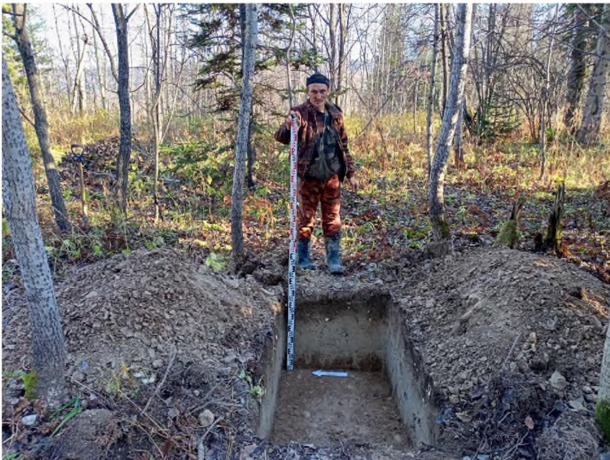
Рис. 164. «Технический проект разработки Увального каменноугольного месторождения». Участок 2. Шурф №10 после выборки. Фото с 3.
