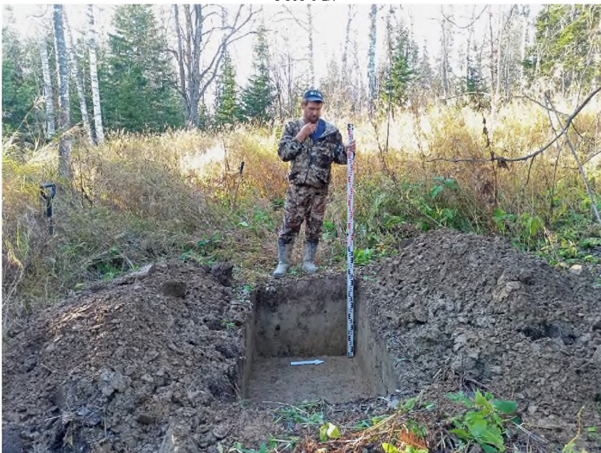
Рис. 192. «Технический проект разработки Увального каменноугольного месторождения». Участок 2. Шурф №17 после выборки. Фото с В.
