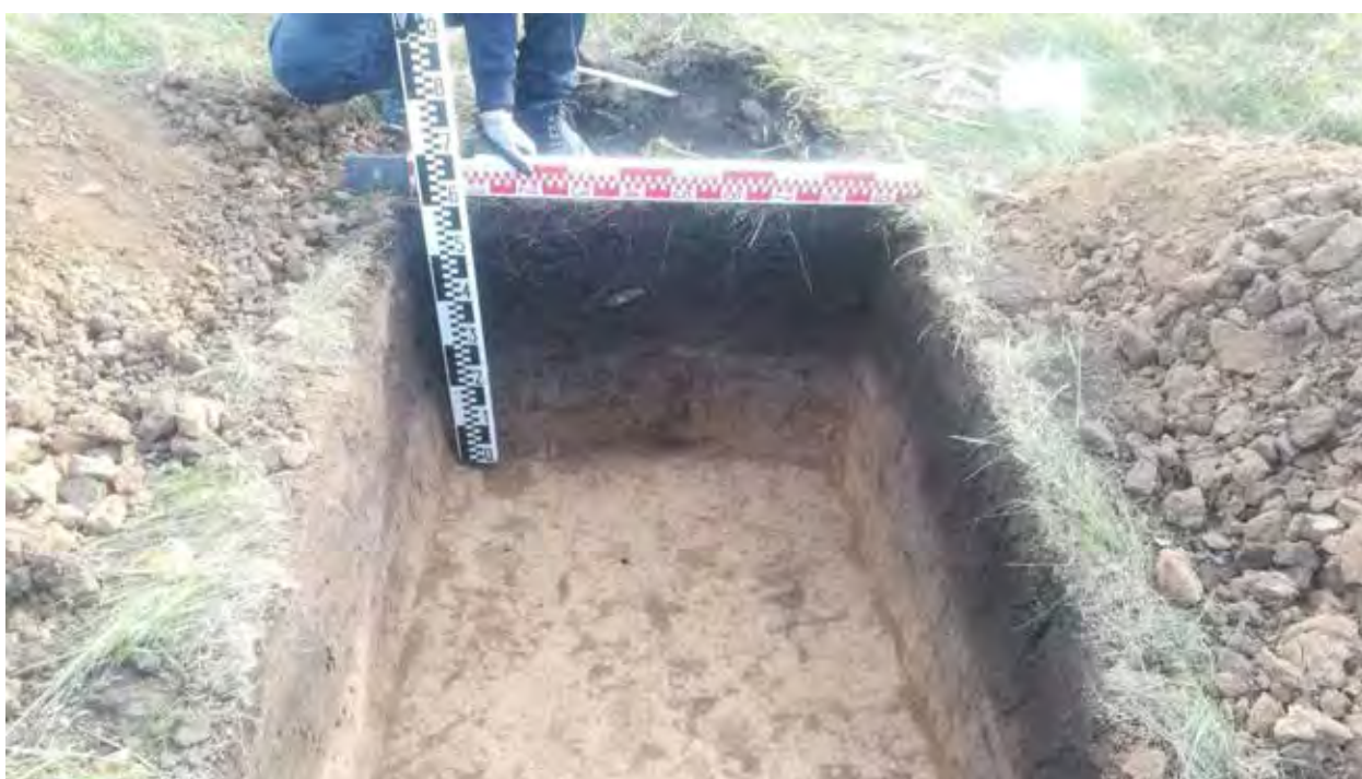
Рис. 98. Объект «Обогатительная фабрика «Шахта Сибирская». Шурф 7, профиль южной стенки.
