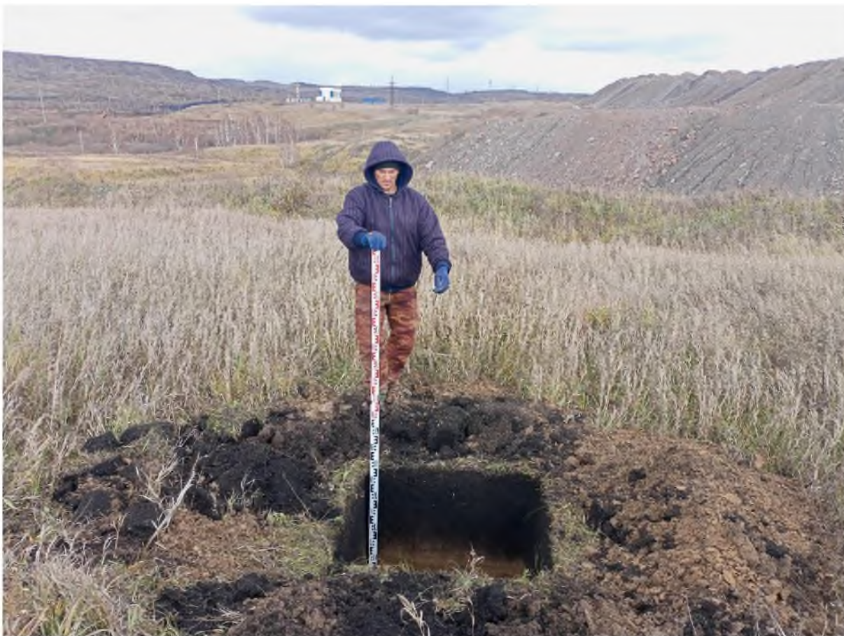
Рис. 222. «Технический проект разработки Караканского...». Участок 3. Шурф №14 после выборки. Фото с Ю.
