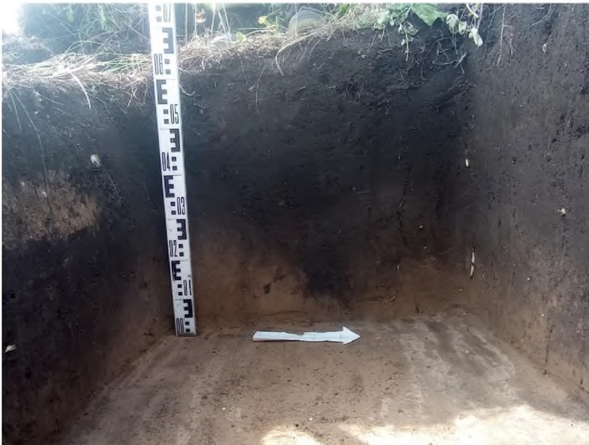
Рис. 381. «Проект обработки участка «Сартакинский-2». Шурф №13. Профиль западной стенки. Фото с В.
