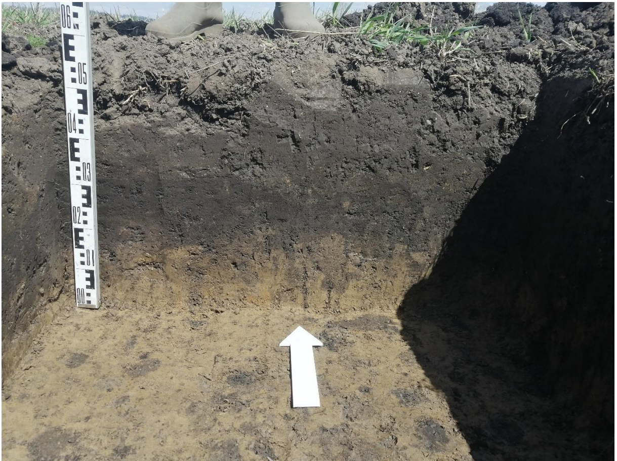
Рис. 57. «Строительство водовода от бункера существующих скважин до узла II подъема...». Шурф №3. Профиль северной стенки. Фото с Ю.
