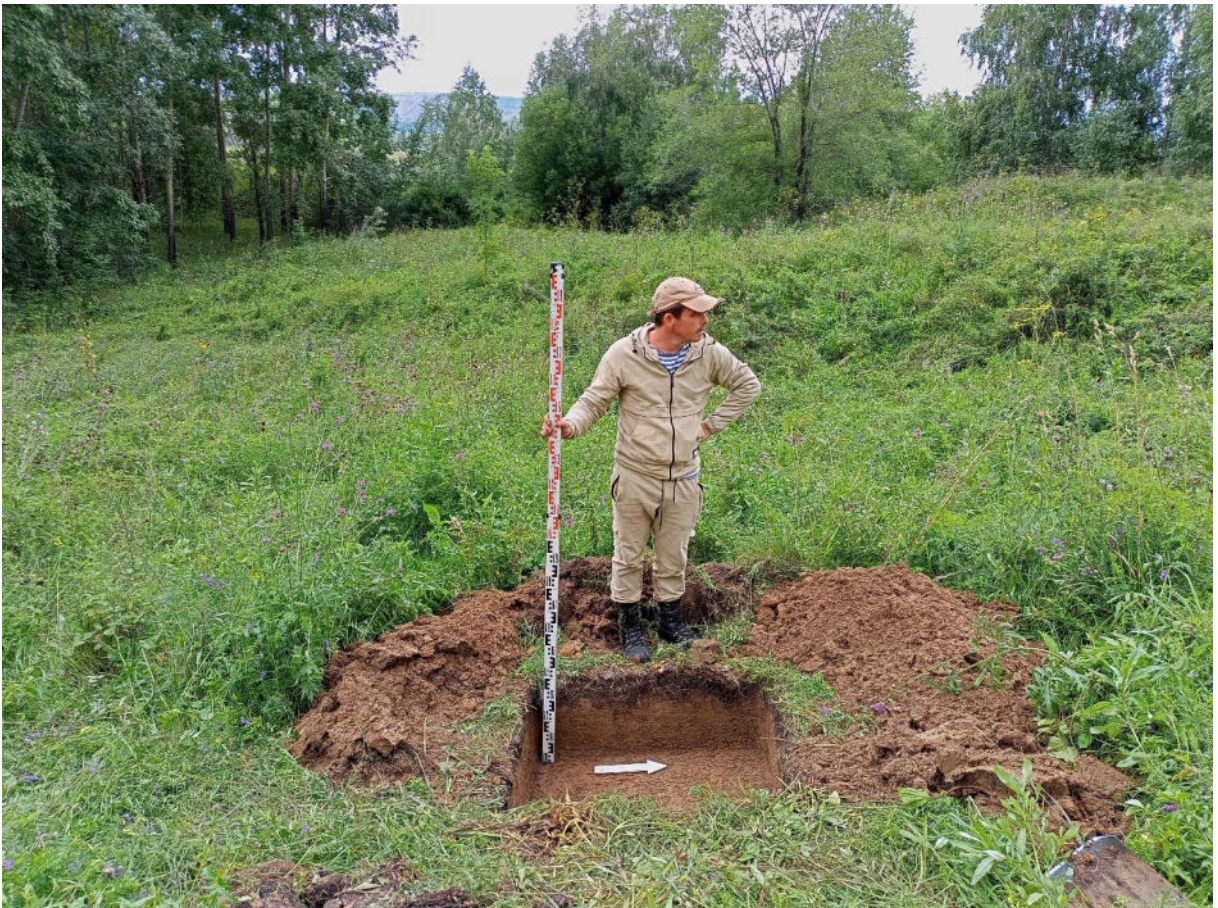
Рис. 282. «Технический проект разработки ... АО «Луговое». Шурф №25 после выборки. Фото с В.
