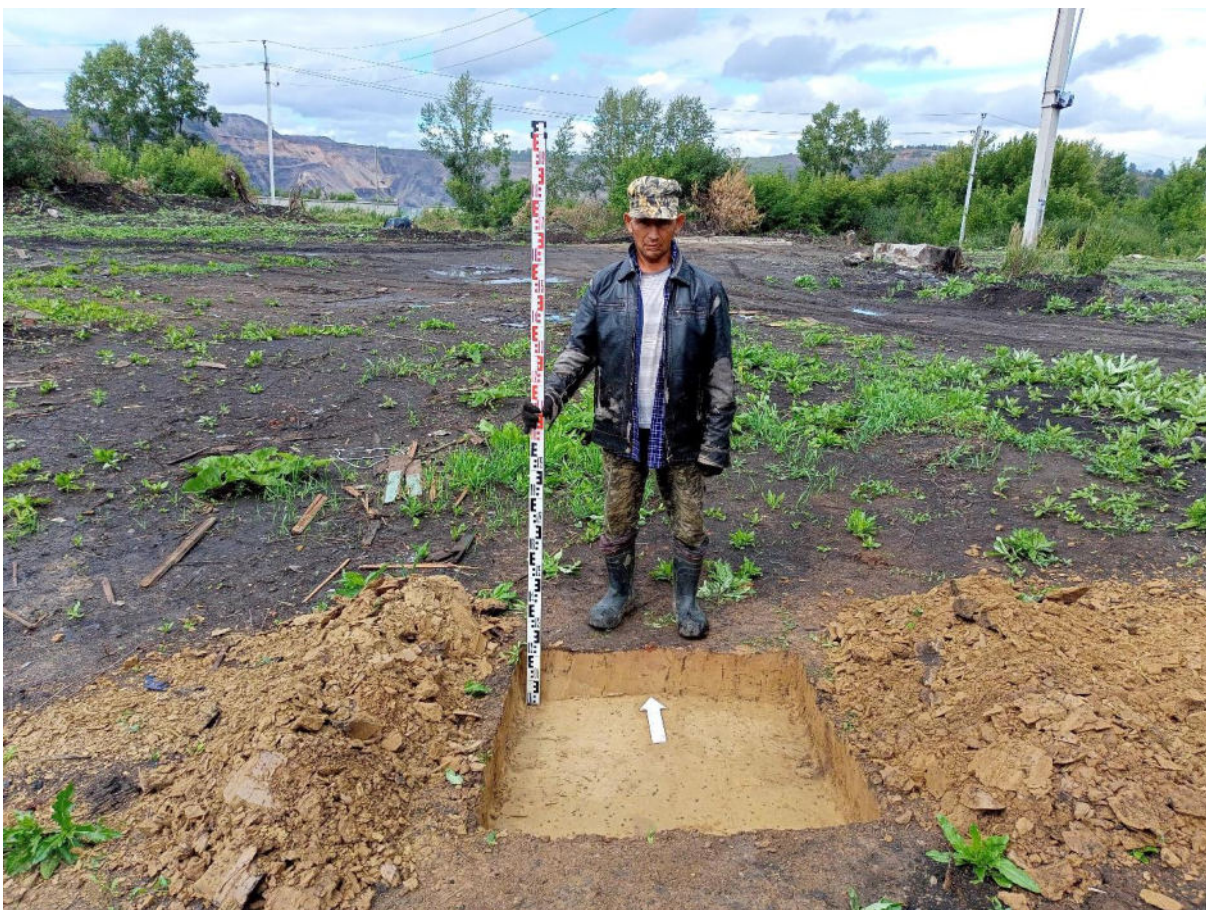
Рис. 210. «Технический проект разработки ... АО «Луговое». Шурф №7 после выборки. Фото с Ю.
