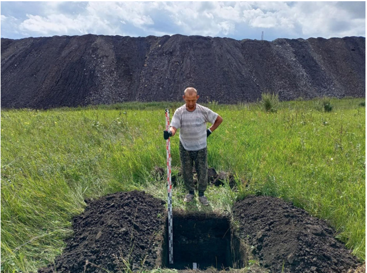
Рис. 318. «Технический проект разработки ... АО «Луговое». Шурф №34 после выборки. Фото с С.
