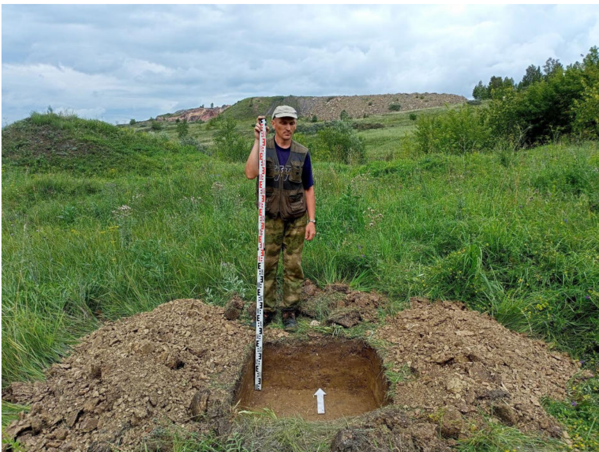
Рис. 266. «Технический проект разработки ... АО «Луговое». Шурф №21 после выборки. Фото с Ю.
