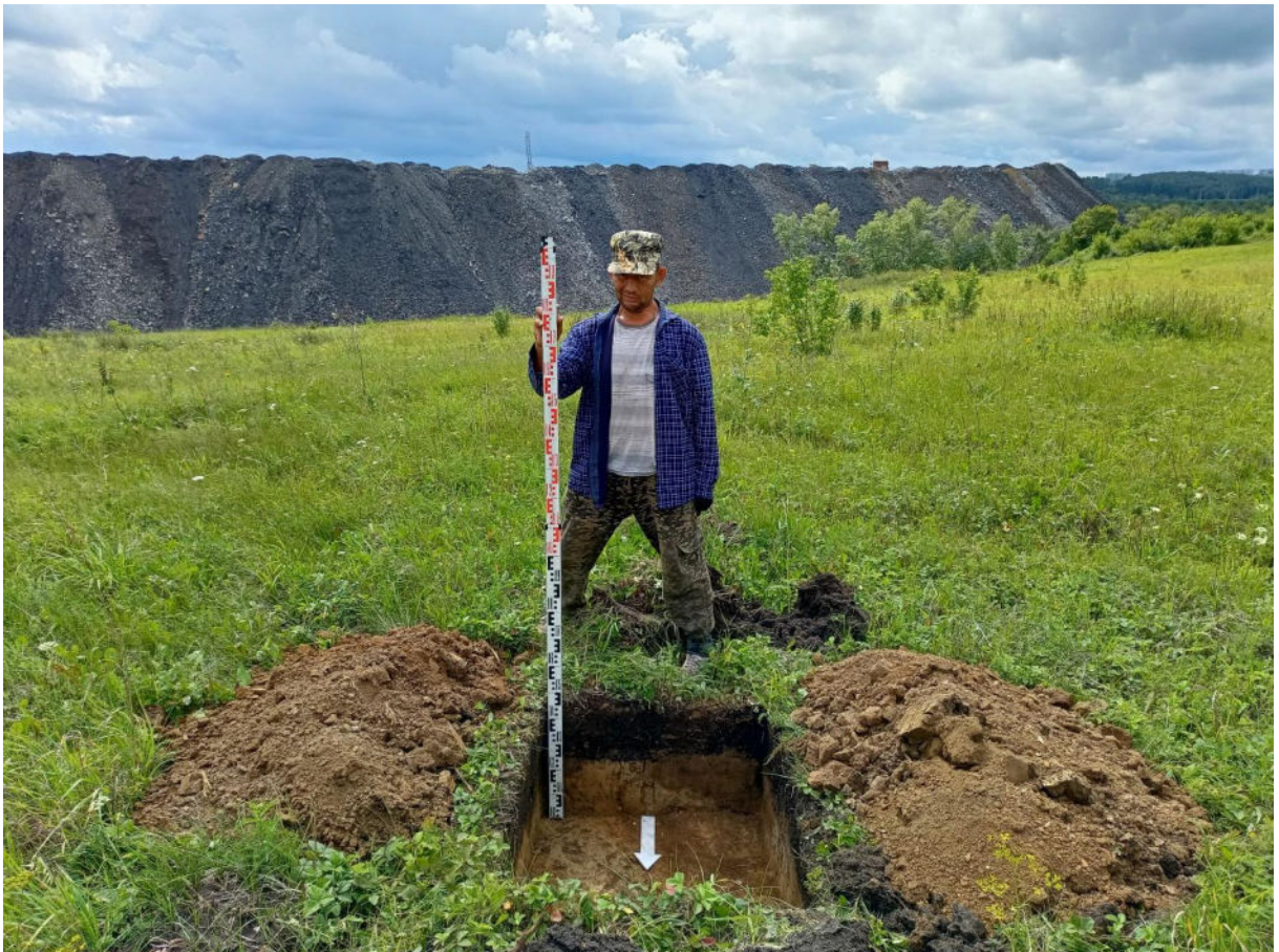
Рис. 314. «Технический проект разработки ... АО «Луговое». Шурф №33 после выборки. Фото с С.
