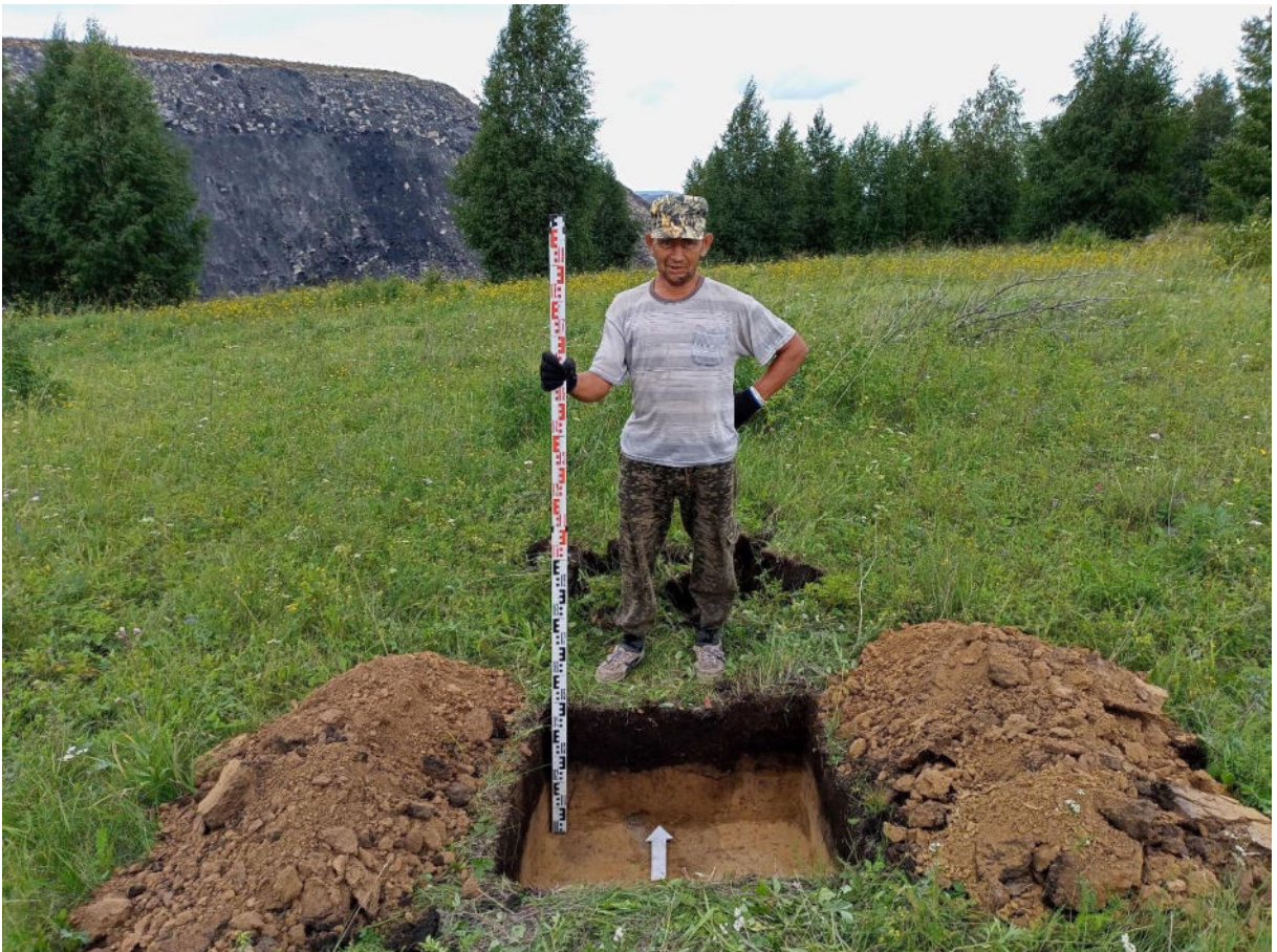
Рис. 322. «Технический проект разработки ... АО «Луговое». Шурф №35 после выборки. Фото с Ю.
