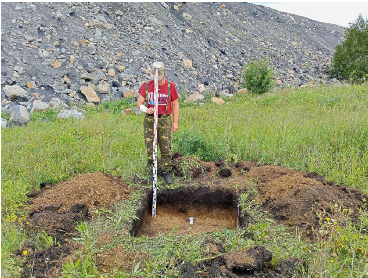
Рис. 302. «Технический проект разработки ... АО «Луговое». Шурф №30 после выборки. Фото с Ю.
